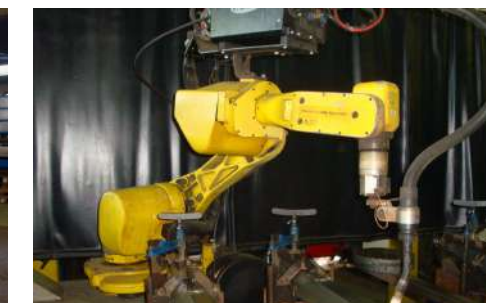
Robot de soldadura
