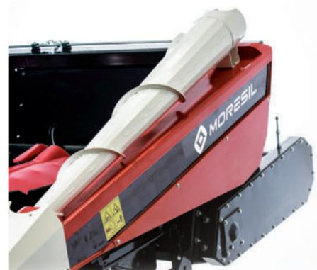
En uno o ambos lados del cabezal, con accionamiento hidráulico (laterales en polietileno o metálicos) o mecánico (laterales metálicos).
