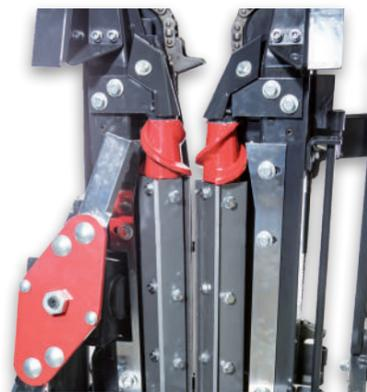
El cabezal MR-800 puede ir equipado con rulos con cuchillas opuestas o alternas según la necesidad del cliente y las condiciones de la cosecha.
